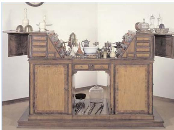
*Collezionismo lorenese. Banco chimico del sec. XVIII. Ha la forma di uno stipo. Aperto presenta un piano di lavoro con tre cavità, una delle quali è collegata internamente ad un mantice azionabile mediante pedali e poteva essere usata per operazioni di combustione e calcinazione. È provvisto di piccoli scaffali, di scomparti e di cassetti. (Per gentile concessione del Museo Galileo di Firenze)*
